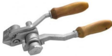
Máquina de cintar e cortar com catraca, usada para colocação de fita de inox  $\frac{3}{4}$  em postes.
