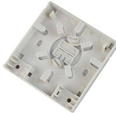
Ponto de terminação óptica (PTO ou roseta) de polietileno para até quatro conectores de padrão SC. Tem a função de abrigar a emenda de fibra óptica ou conectorização dentro da casa do cliente final.
